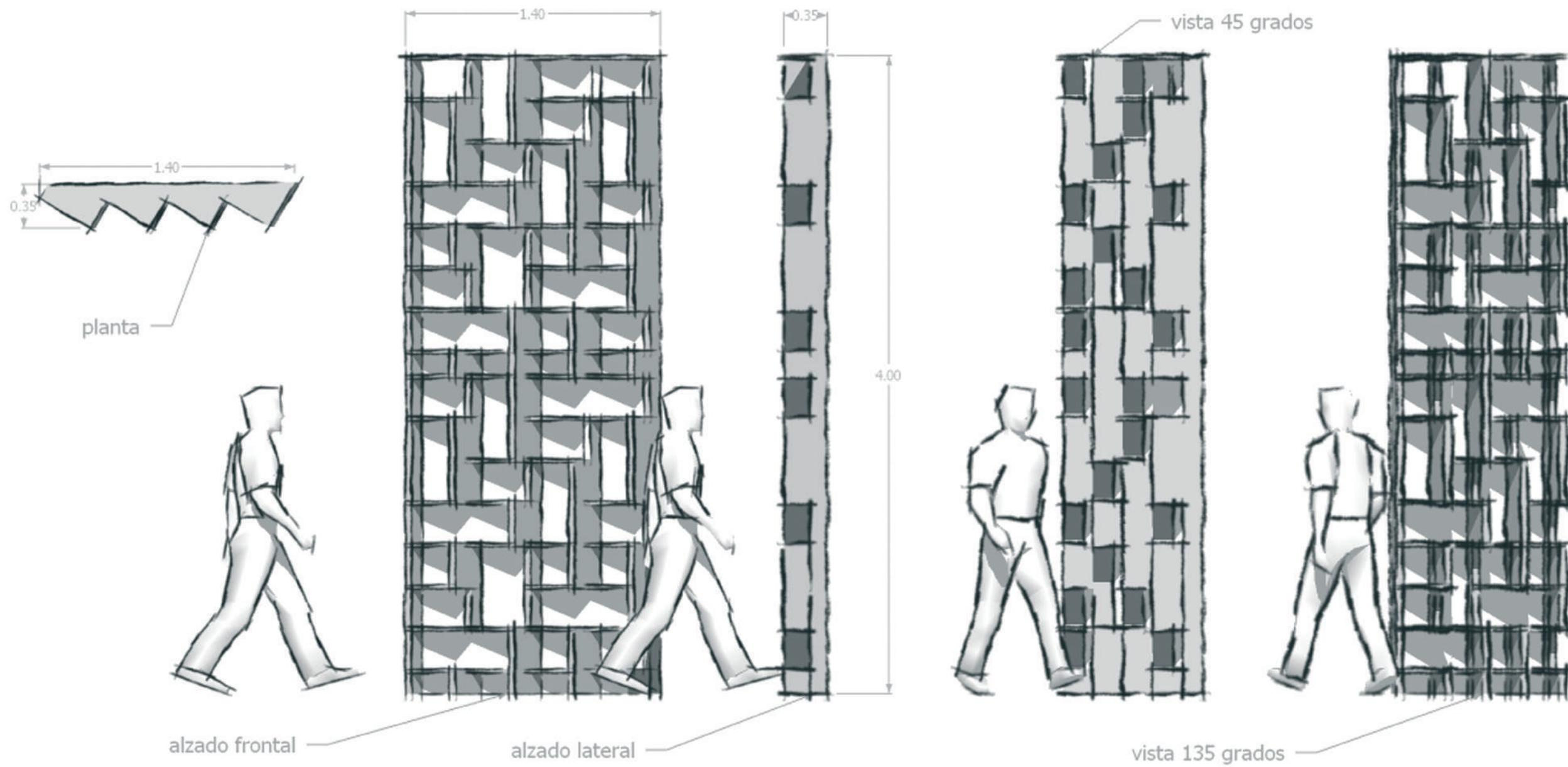
Fabricado en tambor de triplay de madera enchapada, por su dimensión (4.00 metros de altura por 1.40 metros de ancho) resulta un mueble adecuado en dobles alturas, aunque también se ha diseñado en el tamaño convencional (2.00 metros de altura por 1.20 metros de ancho).
