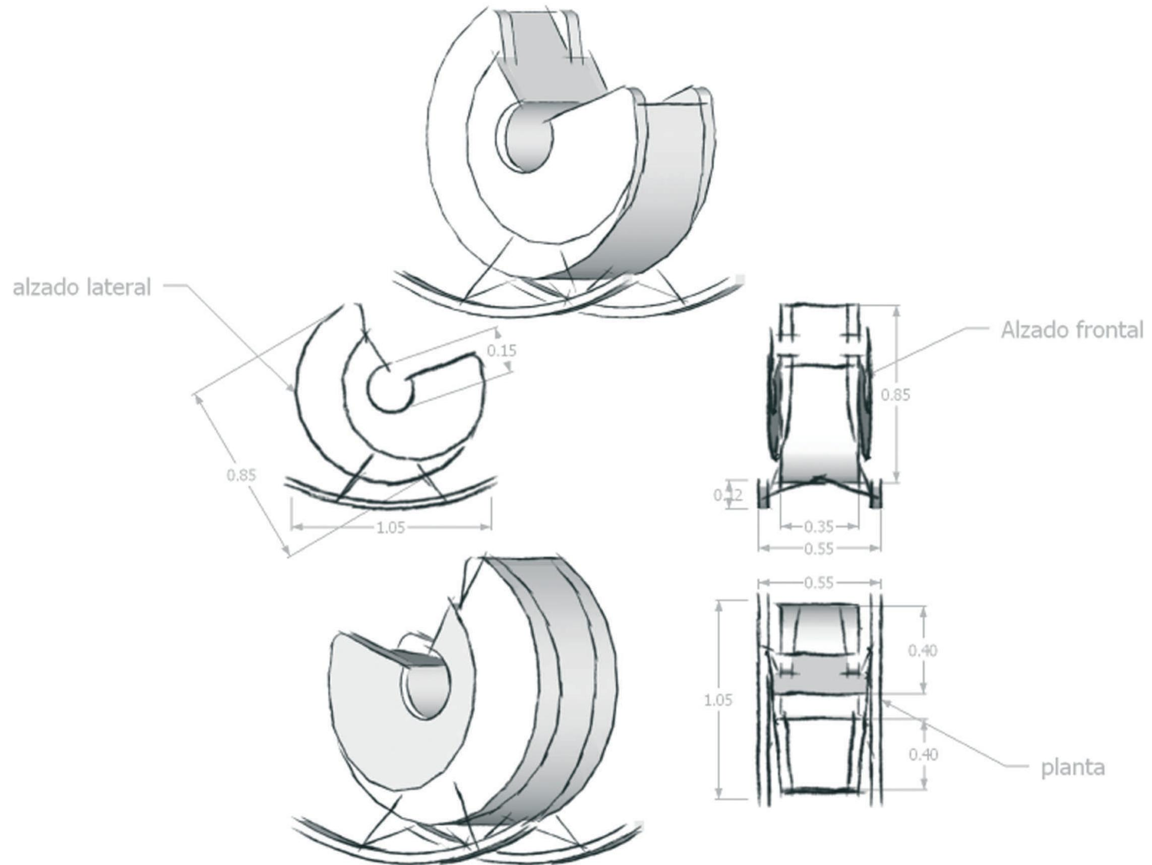
El objeto se armó con piezas de madera, cubriendo estas con textiles naturales, donde crea un sólido, y junto con sus extensiones inferiores de acero cromado utilizadas de soporte, en su silueta nos muestra la idea de un vehículo, el objetivo es convertir el mueble en un que-hacer interactivo multifuncional.
