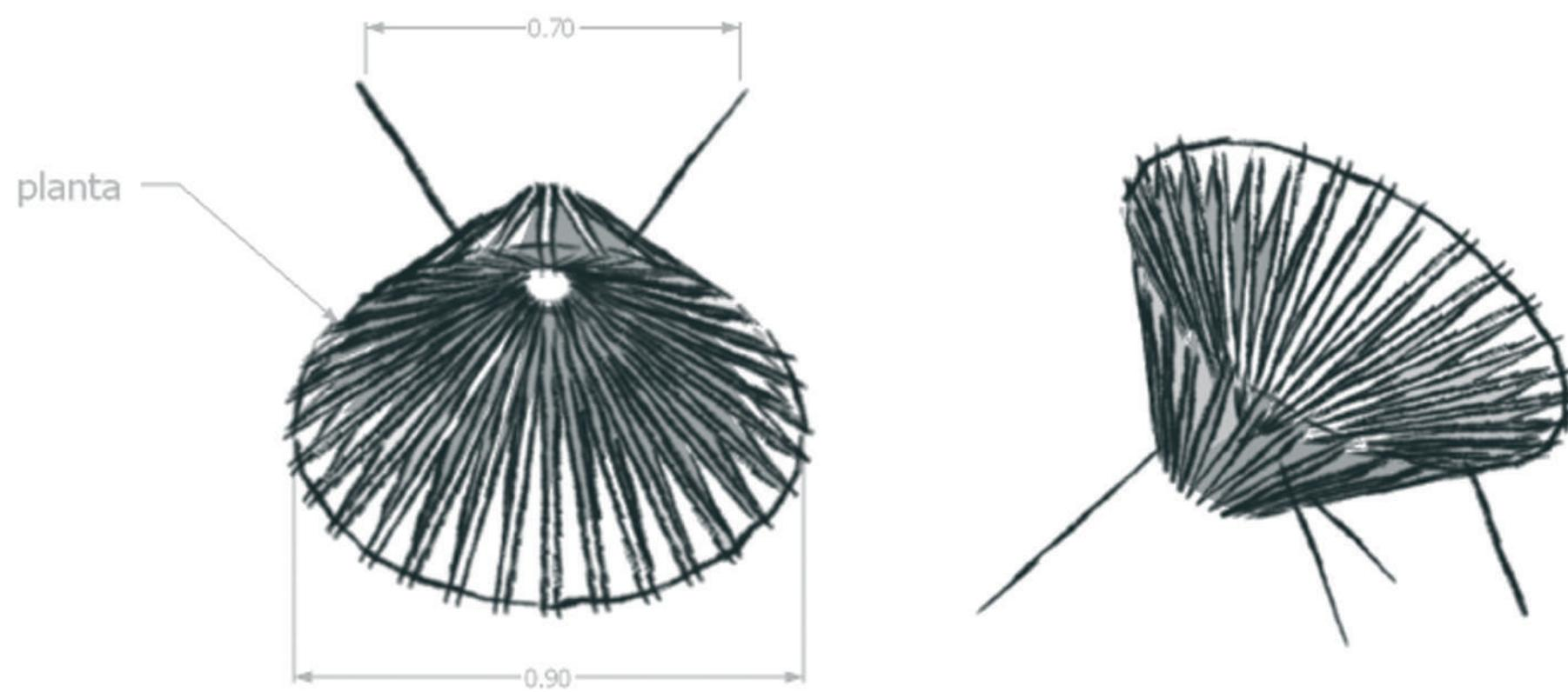
Mueble de madera maciza de banak en secciones rectangulares con longitudes variadas, fabricado a mano en su armado y pegado con resistol blanco y pijas de 3", un metro de diámetro, la base es una estructura de acero, en redondo de  $\frac{1}{2}$ , acabado pintura negra matizada, con tejido de telas.
