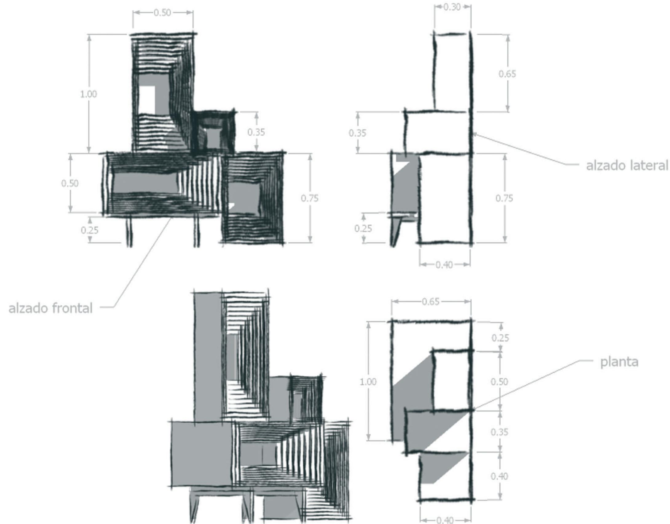
Las puertas carecen de una cubierta completamente cerrada, en cambio sugiere el interior, entre marco y marco hay una separación de 1 cm que le da ligereza a la estructura, el resultado es un mueble que interacciona en su interior y su exterior con el contexto en general, no es una cámara obscura, permitiéndonos diseñar su contenido, su acomodo y sus matices al interior.
